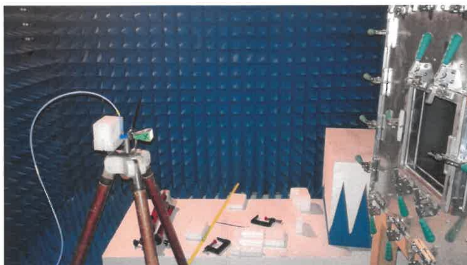
Obrázek 8 Měření reference v kmitočtovém rozsahu E3, vertikální polarizace
