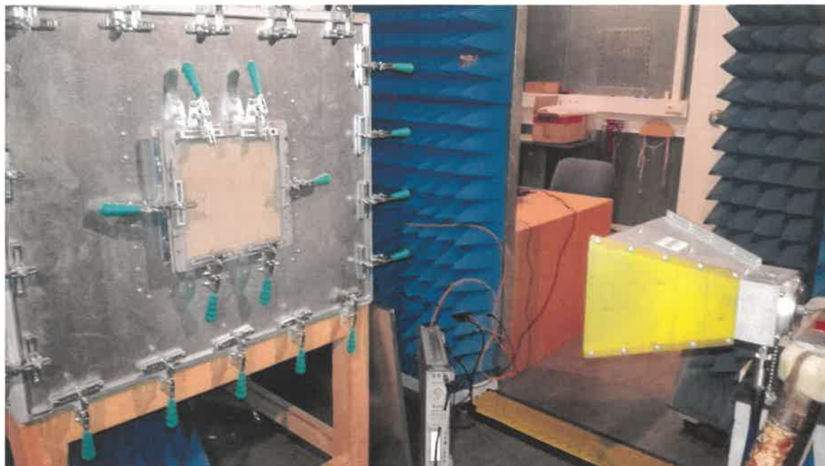
Obrázek 5 Měření EUT – pásmo E2, vzorek 9/2022 ze zadní strany, vertikální polarizace
