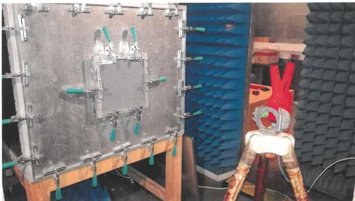
Obrázek 9 Měření EUT – pásmo E3, vzorek 9/2022 z přední strany, vertikální polarizace
