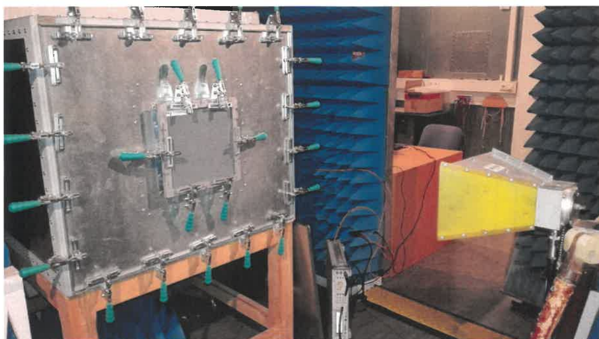
Obrázek 6 Měření EUT – pásmo E2, vzorek 9/2022 z přední strany, vertikální polarizace
