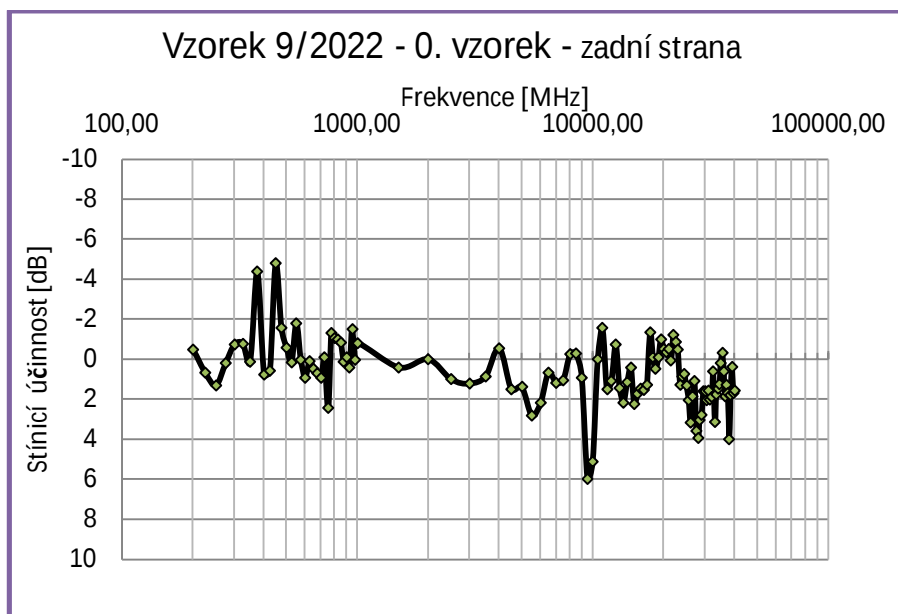
Obr. 17: EMC vzorku laminátu 9/2022 - 0. vzorek - zadní strana (frekvence – logaritmická stupnice)
