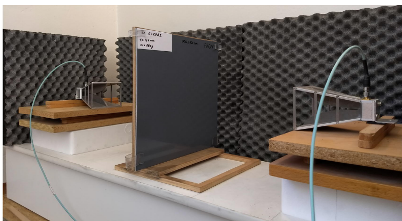
Obr. 8: Ukázka sestavy při měření vloženého útlumu na odraz a průchod elektromagnetického záření
