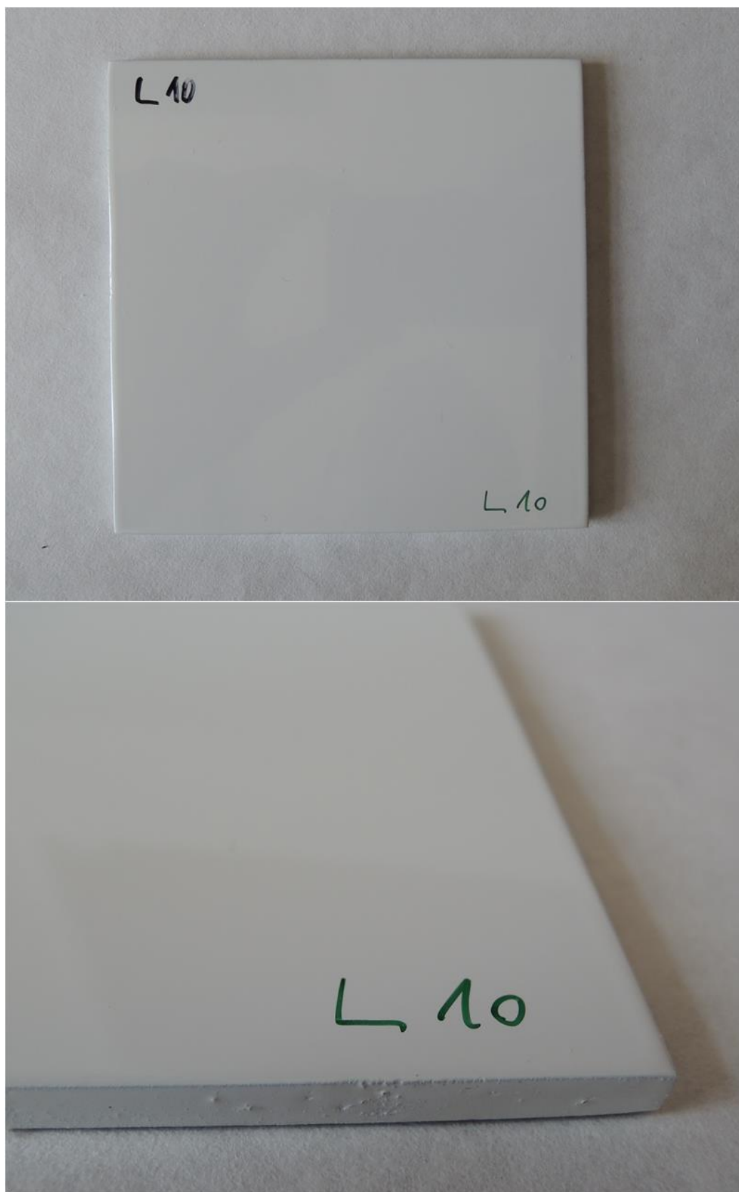
Obr. 31. Vzorek hybridního laminátu L10 – Prototyp hybridních laminátů s radiačním cloněním.
