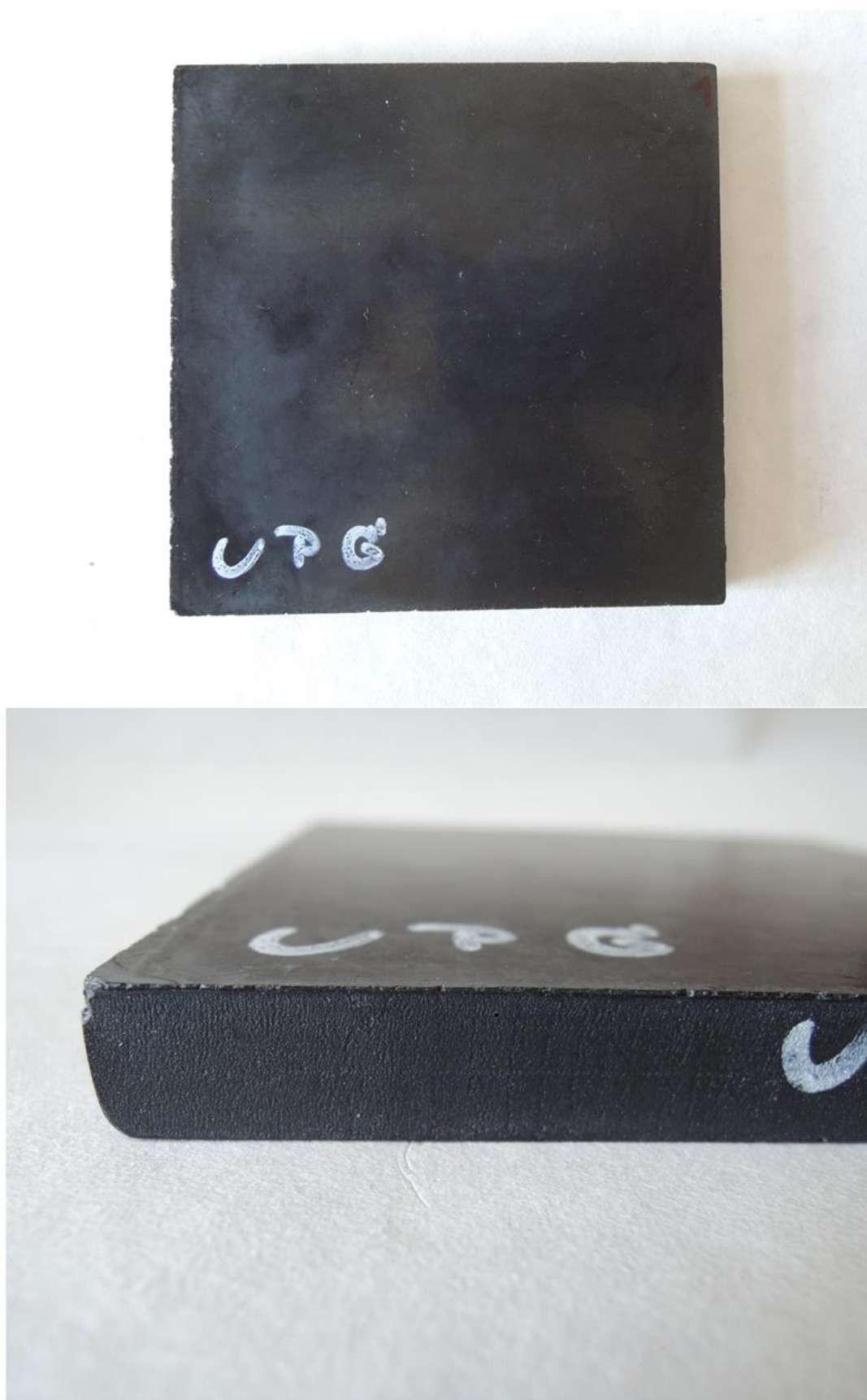
Obr. 3. Testovací vzorek částicového kompozitu UPG pro stanovení lineárního součinitele zeslabení.
