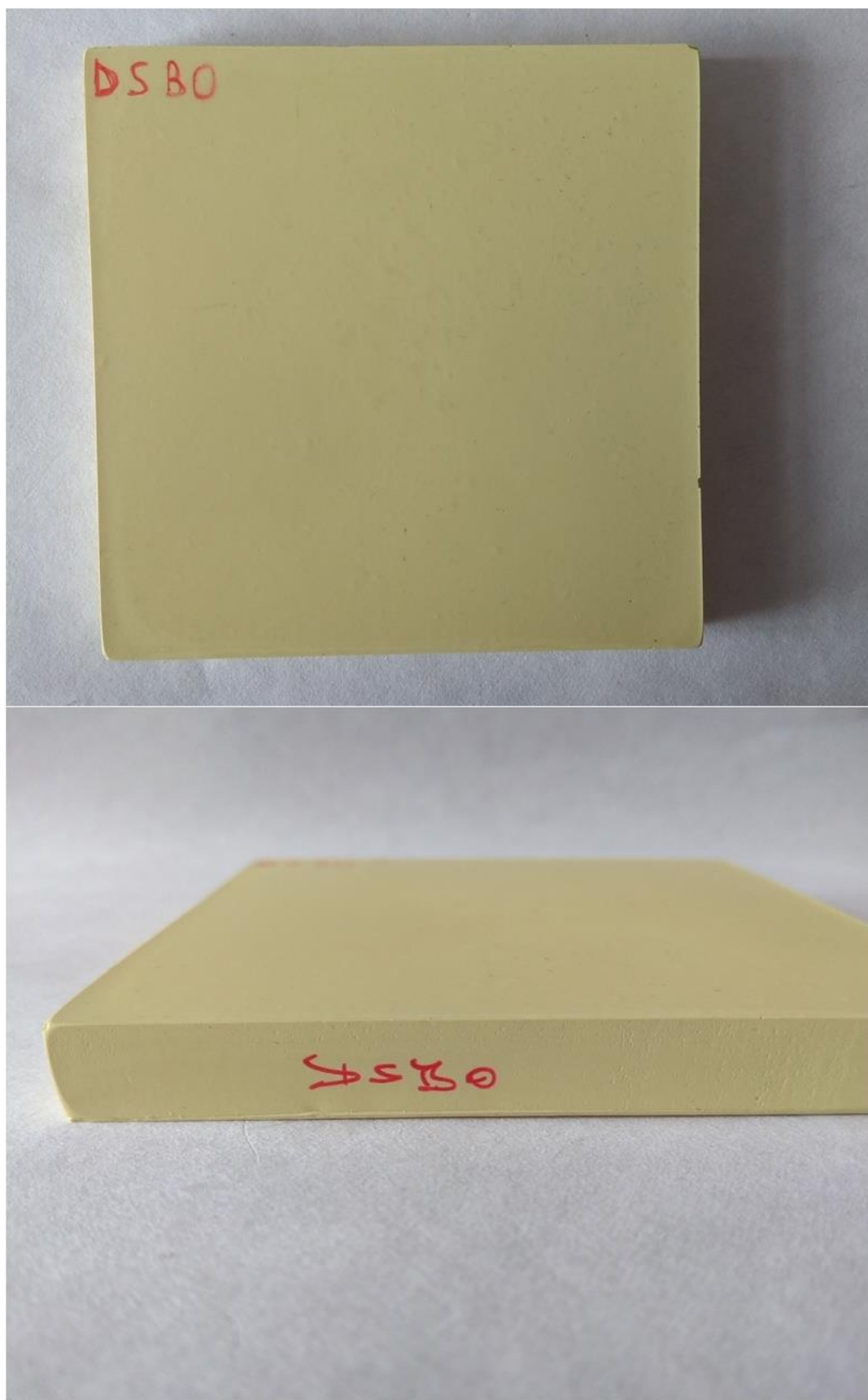
Obr. 10. Testovací vzorek částicového kompozitu DSBO pro stanovení lineárního součinitele zeslabení.
