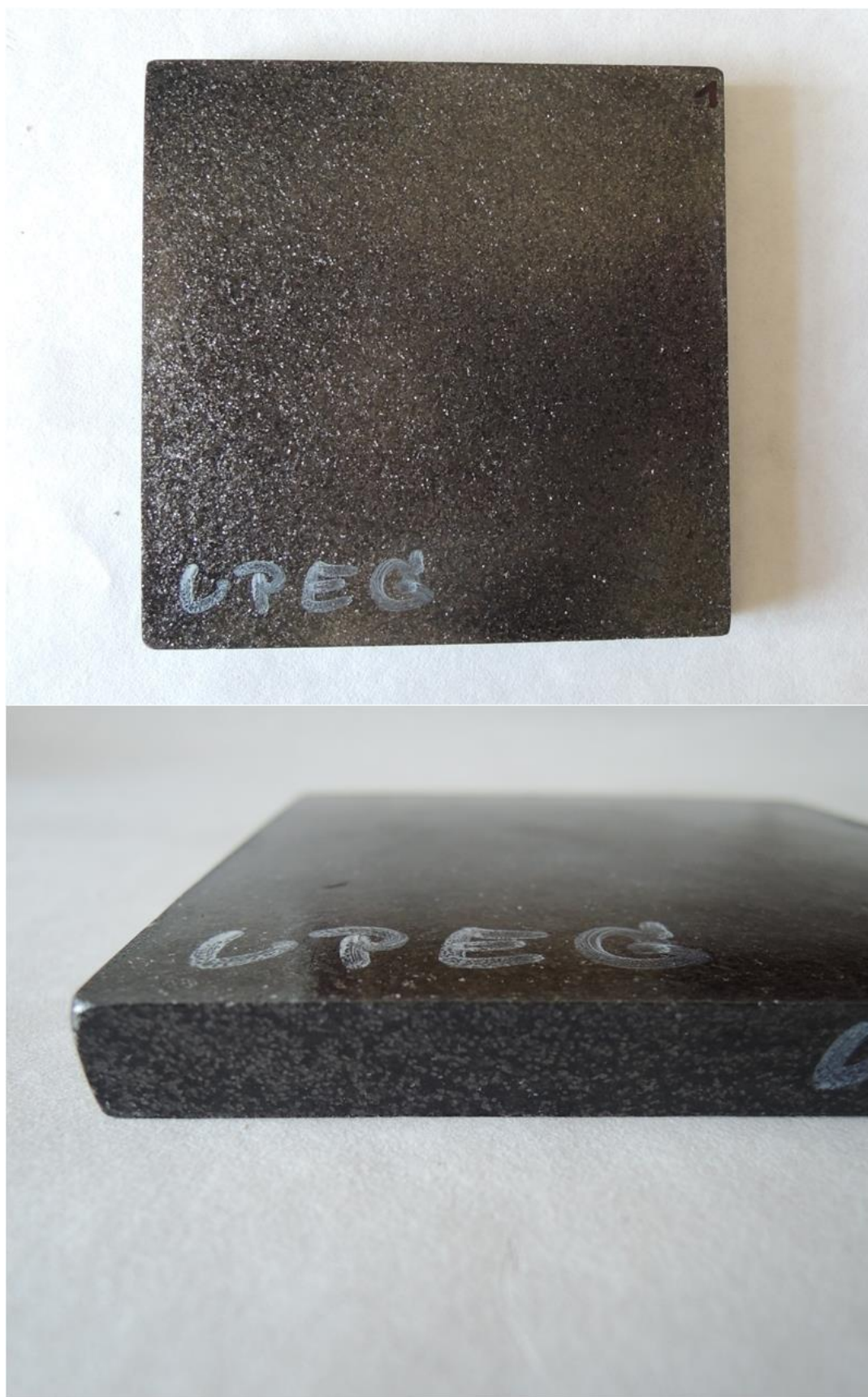
Obr. 4. Testovací vzorek částicového kompozitu UPEG pro stanovení lineárního součinitele zeslabení.
