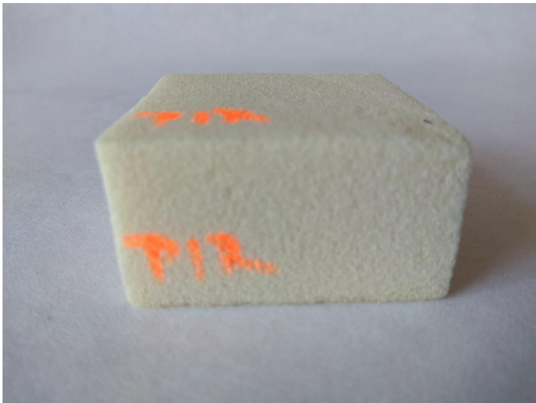
Obr. 4. Vzorek termoizolační vrstvy PIR.
