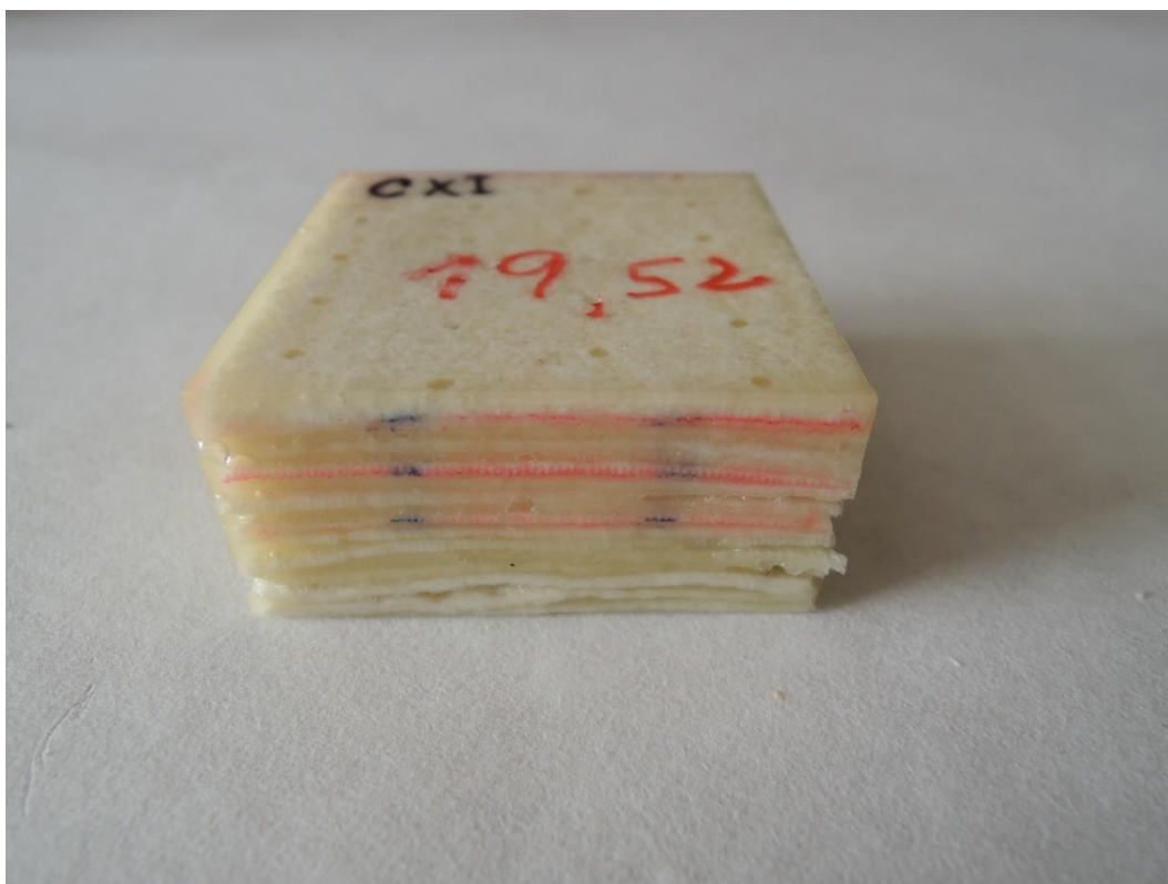
Obr. 7. Vzorek termoizolační vrstvy CXI.
