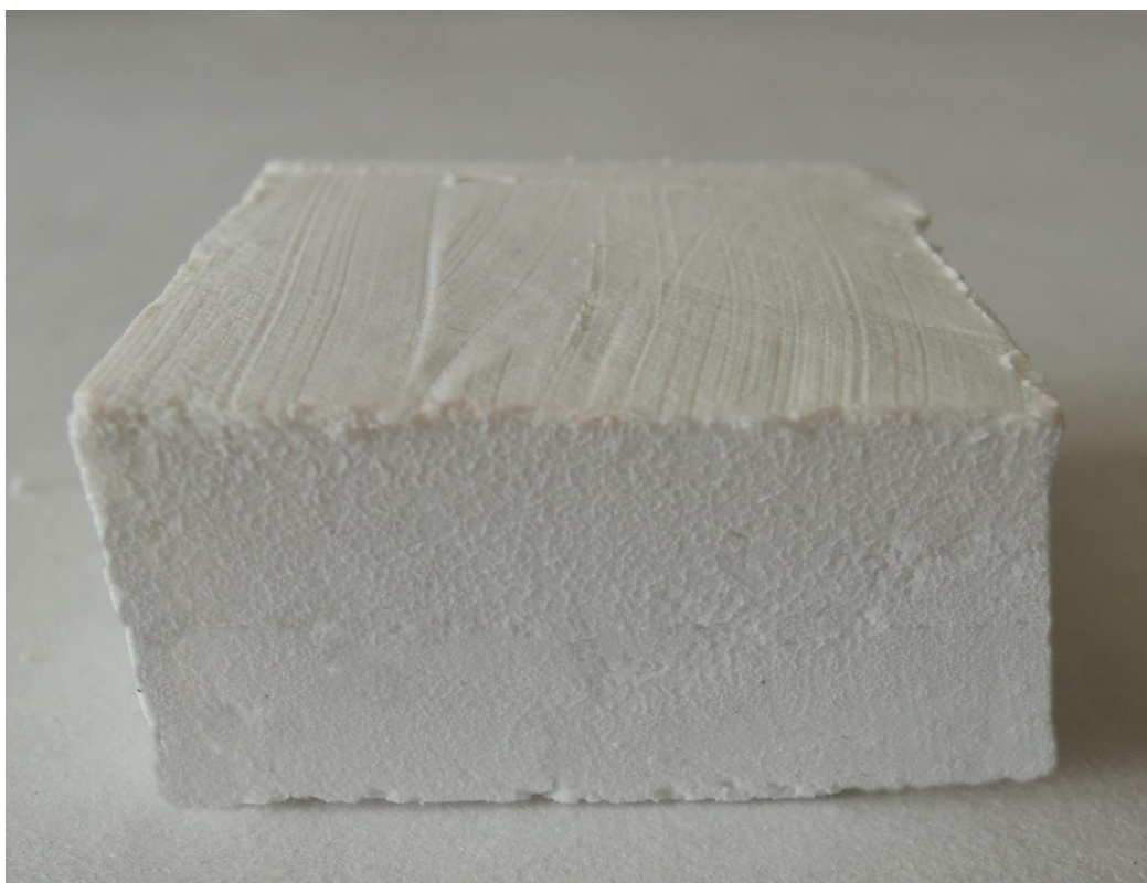
Obr. 11. Vzorek termoizolační vrstvy PHX – receptura HX1-BI10.
