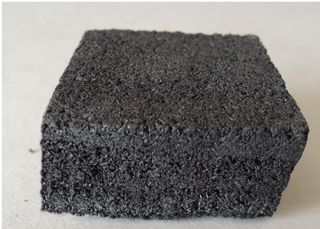
Obr. 12. Vzorek termoizolační vrstvy MFEG – receptura EG1-MC10-BI4.
