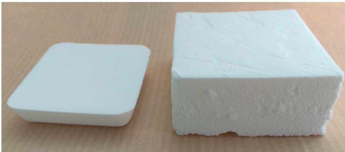
Obr. 17. Testovací prototyp laboratorně připravené termo-izolační desky TIS1 (vzorek HX1-BI10 ) pro optimalizaci koncentrace PVAc (vlevo) a testovací tělísko pro stanovení součinitele tepelné vodivosti (vpravo).
