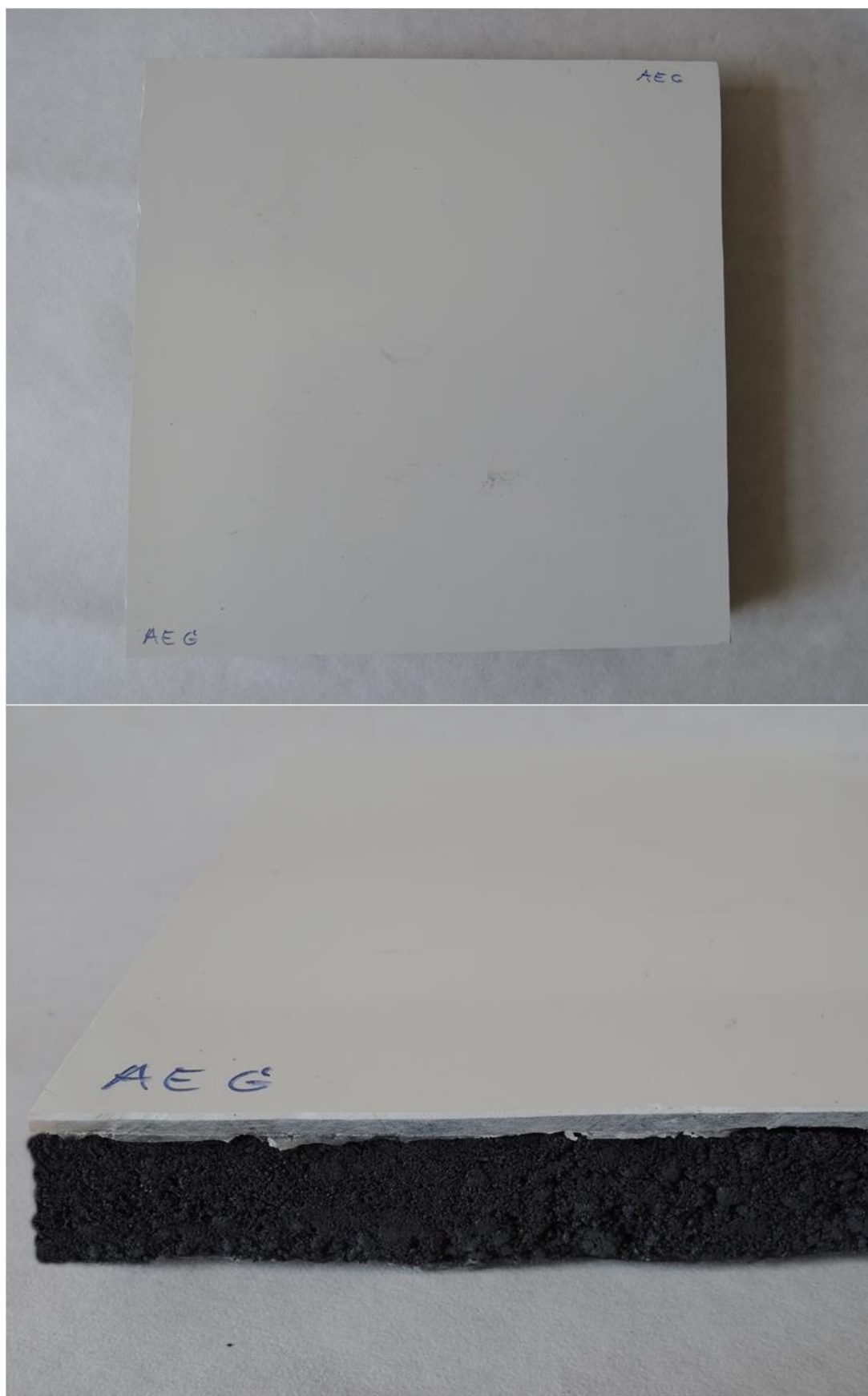
Obr. 30. Vzorek termoizolačního hybridního laminátu AEG.
